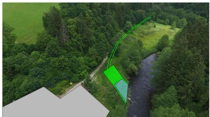
Standort neue Wasserkraftanlage und Unterflur-Rohrleitung (beides grün dargestellt)
